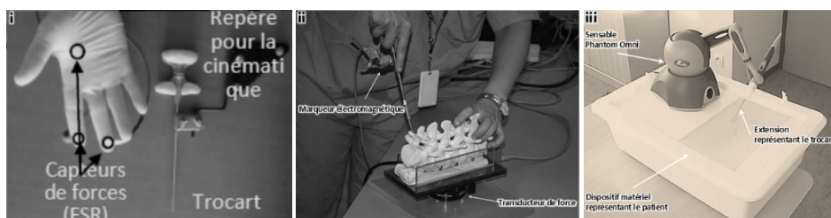
Figure 3 • (i), (ii) Instrumentations pour le recueil des données gestuelles et haptiques relatives à la manipulation du trocart. (iii) Bras haptique et dispositif matériel dans l'environnement de simulation
