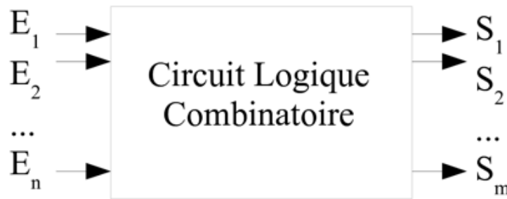
Figure 3 • Modèle d'un circuit logique combinatoire
